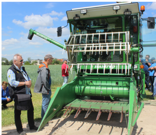
Specjalny kombajn do zbioru rzepaku z poletek doświadczalnych jest wyposażony w komputer, w wagę i urządzenie do pomiaru wilgotności oraz drukarkę etykiet z kodem kreskowym
